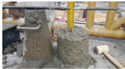
Gambar 4.6 Hasil Uji Slump
