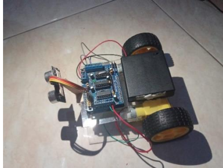
Gambar 4.4 Pemasangan Sensor Ultrasonik HC-SR04
