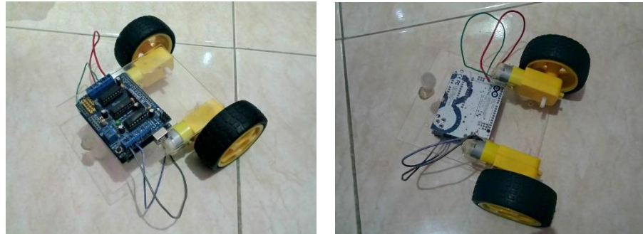
Gambar 4.2 Pemasangan Arduino Uno, Driver Motor Shield L239D, dan Motor DC
