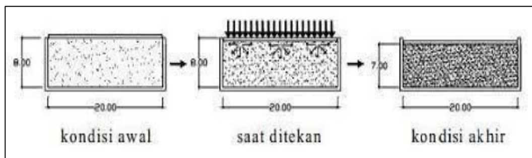
Gambar 2.11 Prinsip Kerja Metode Mekanis
