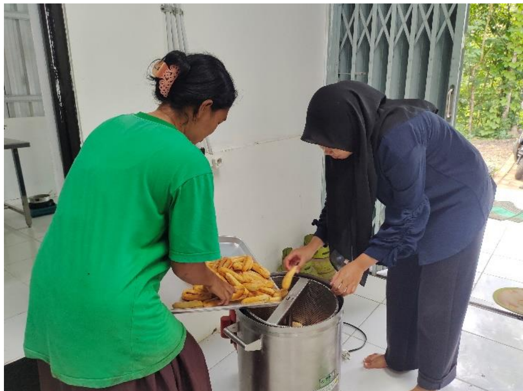
Gambar 13. Proses penirisan minyak dengan mesin spinner
