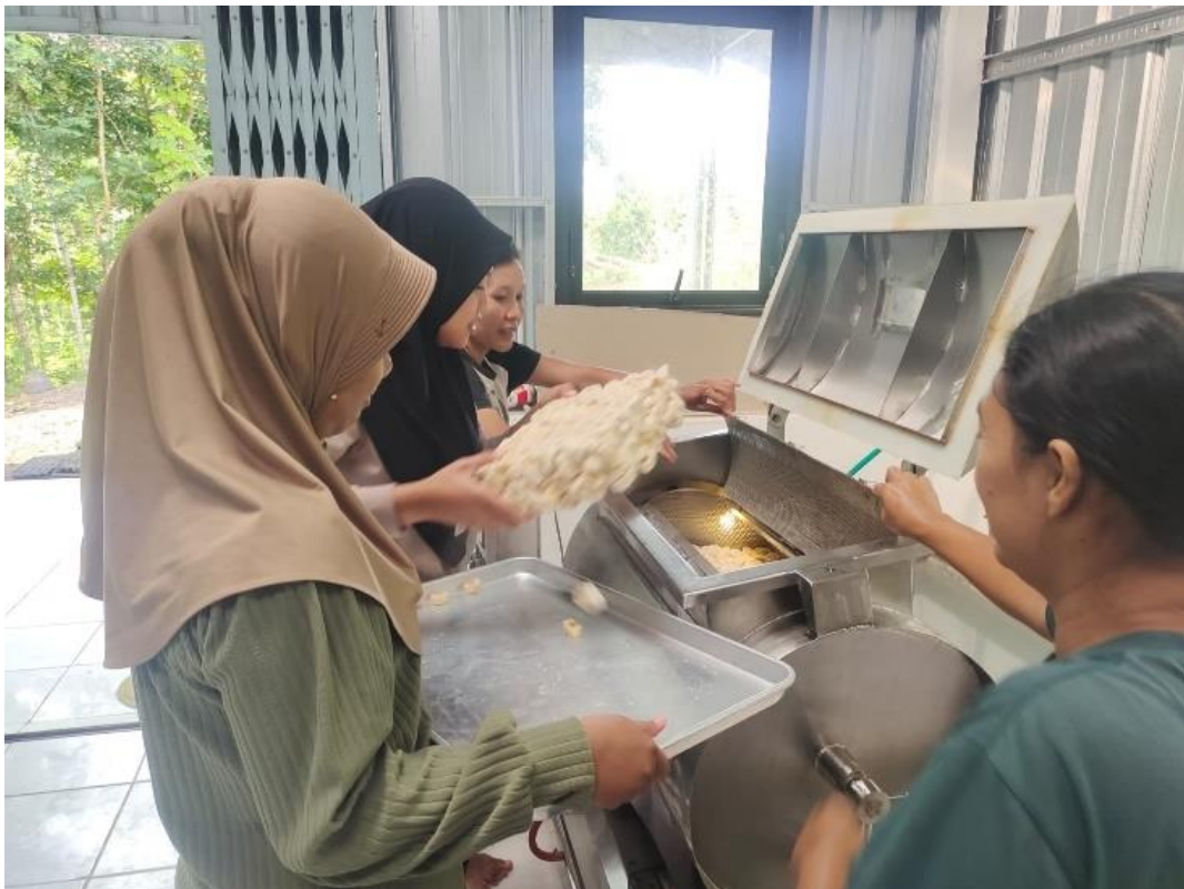
Gambar 11. Proses penggorengan keripik dalam mesin vacuum
