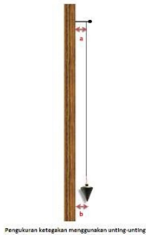
Pengukuran ketegalan menggunakan unting-unting
