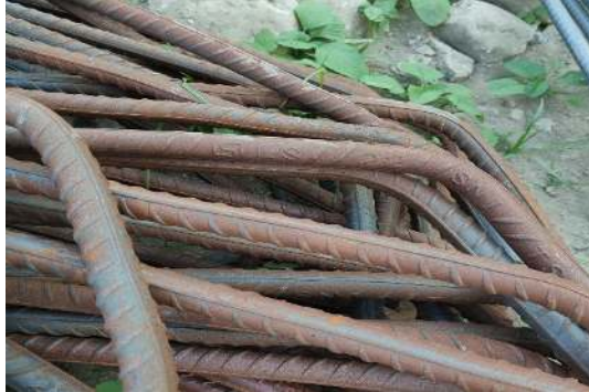
Gambar 4.3 Besi tulangan ulir (sirip) diameter 22 mm
