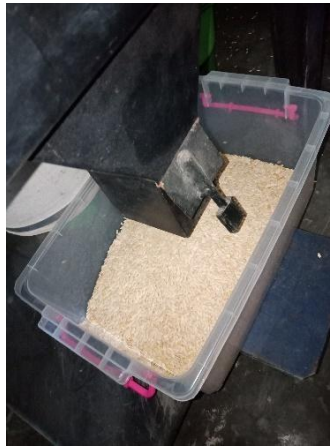
Gambar 8 Proses sortasi benih melon menggunakan mesin Grading/Gravity
