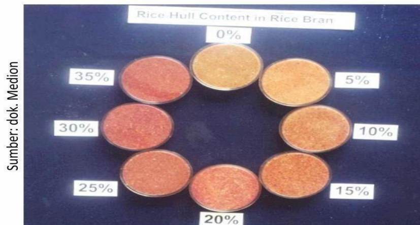
Uji Flouroglucinol Semakin tinggi kontaminasi sekam warna akan semakin merah
