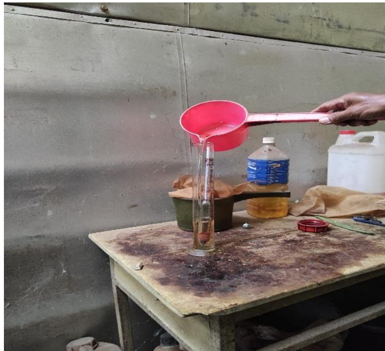
Gambar 4. Pengukuran BJ (Berat Jenis) Minyak Atsiri
