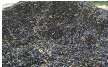
Gambar 4.9 Split ( Sumber : Kerja Praktek 2022 )
