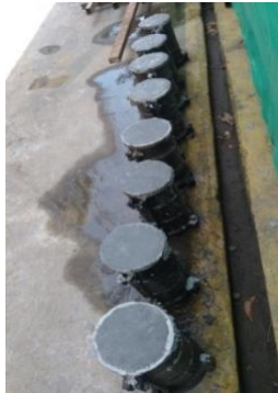
Gambar 4.13 Alat Cetak Benda Uji Beton ( silinder ) ( Sumber : Kerja Praktek 2022 )
