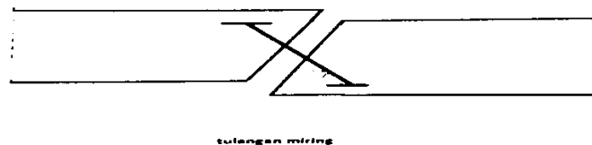
Gambar 2. 26 Retak geser ditahan oleh tulangan longitudinal
