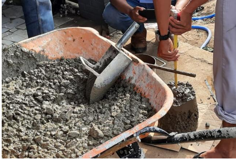
Gambar 4. 5 pengujian semen metode slump
